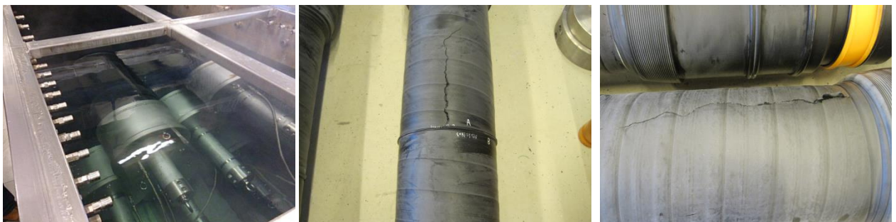
Fig.4 長期静水圧強度試験の様子 Hydrostatic strength test at 80°C
